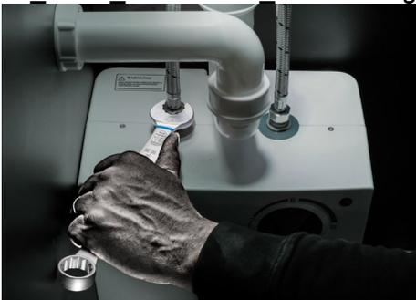
Durch das um  $7,5^\circ$  geschwenkte Maul und die Doppelsechskant-Geometrie wird beim neuen Joker 6003 eine Verdopplung der Ansetzpunkte für einen Rückholwinkel von  $15^\circ$  erzielt.
